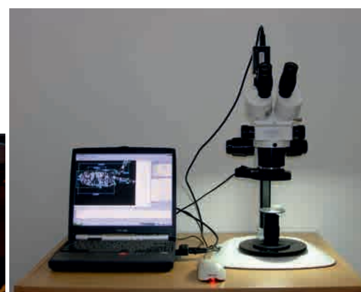
Systém na meranie prelisov konzerv
