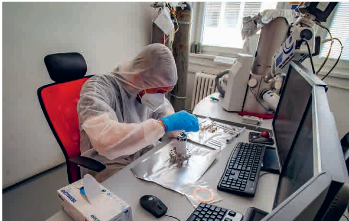
Elektrónový mikroskop MIRA 3 pre KEU PZ SR oddelenie Chémie na analýzu povýstrelových splodín s bohatým vybavením EDX a XRF detektorom ▼
