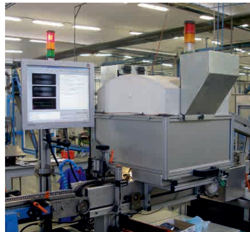
Srdce systému – difúzny všesmerový zdroj svetla s kamerou
