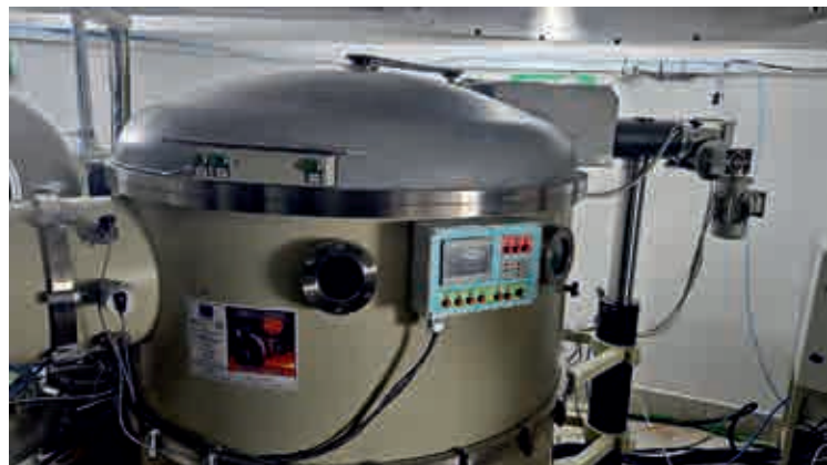
Vákuová naparovačka na zrkadlá pre Astronomický ústav SAV
