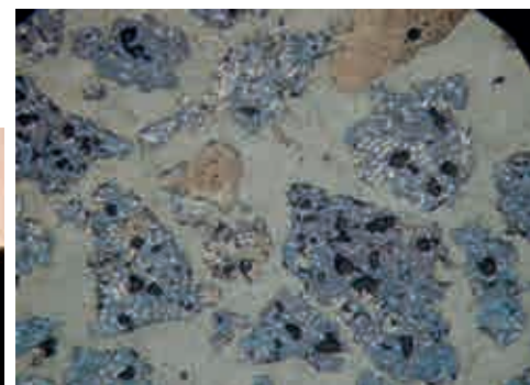
Mineralogická analýza slinku (cementáreň Ladce)
