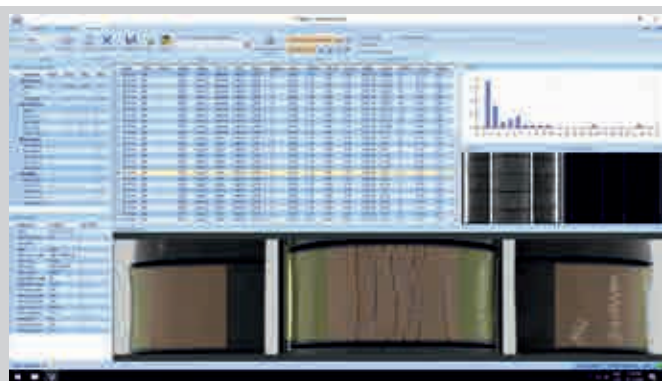
Detekcia a klasifikácia trhlín na gumených vzorkách
