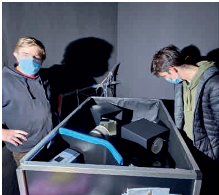
Echelleho spektrograf pre Observatórium na Skalnatom Plese
