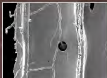
Obr. 8.9 Ruplúra v bunkovej stene jarnej tracheidy (P3)
