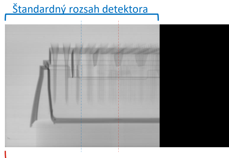
Virtuálne horizontálne rozšírenie detektora o 40%
